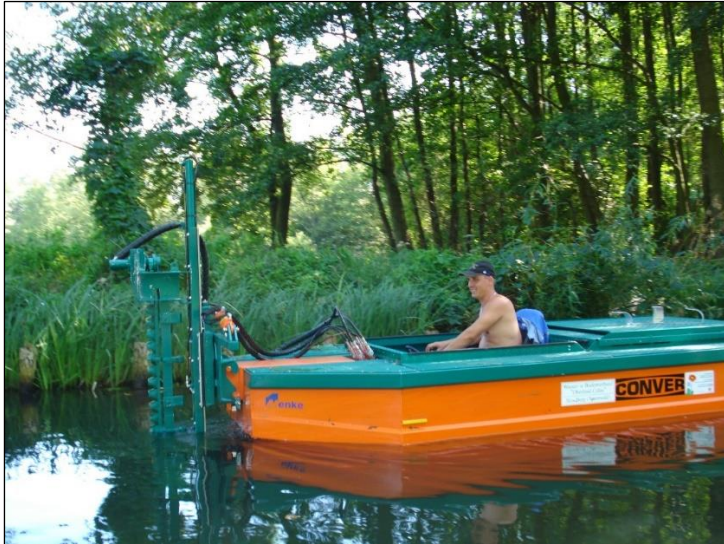
Abbildung 4: Krautmähboot mit T-Mähwerk
